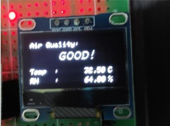
Gambar 3. Display Deteksi Suhu dan Kondisi Aman
