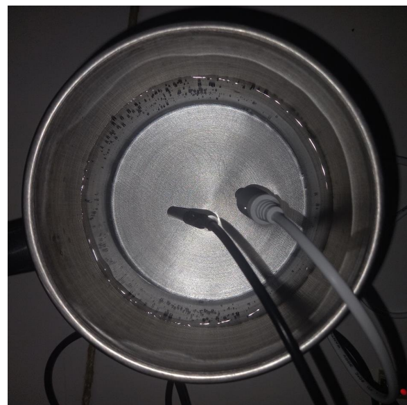
Gambar 6. Mencelupkan sensor suhu dan sensor turbidity (kekeruhan) dalam cangkir dengan air isi ulang
