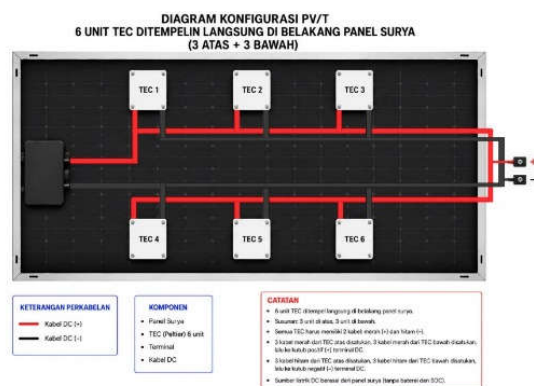
Gambar 2. Diagram konfigurasi sistem pendingin TEC pada panel surya
