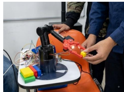
Gambar 4. Lengan robot saat proses sortasi objek
